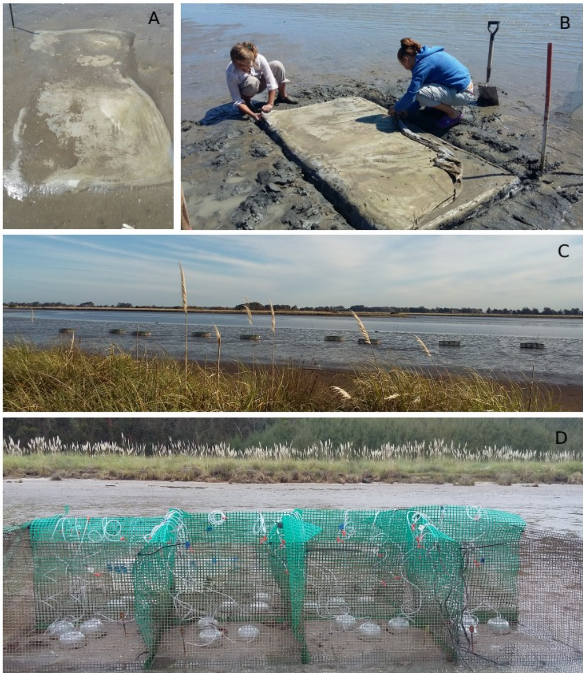
Figura 1. A) Proceso de defaunación en unidades experimentales, B) Remoción de la tela de malla fina luego de 45 días de defaunación, C) Bloques experimentales distribuidos en la planicie de marea, D) Presentación de cámaras bentónicas en cada tratamiento.
